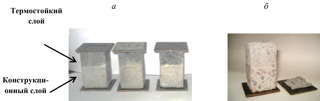
Рис. 7. Состояние контактной зоны двухслойных образцов до (а) и после (б) испытания на отрыв
